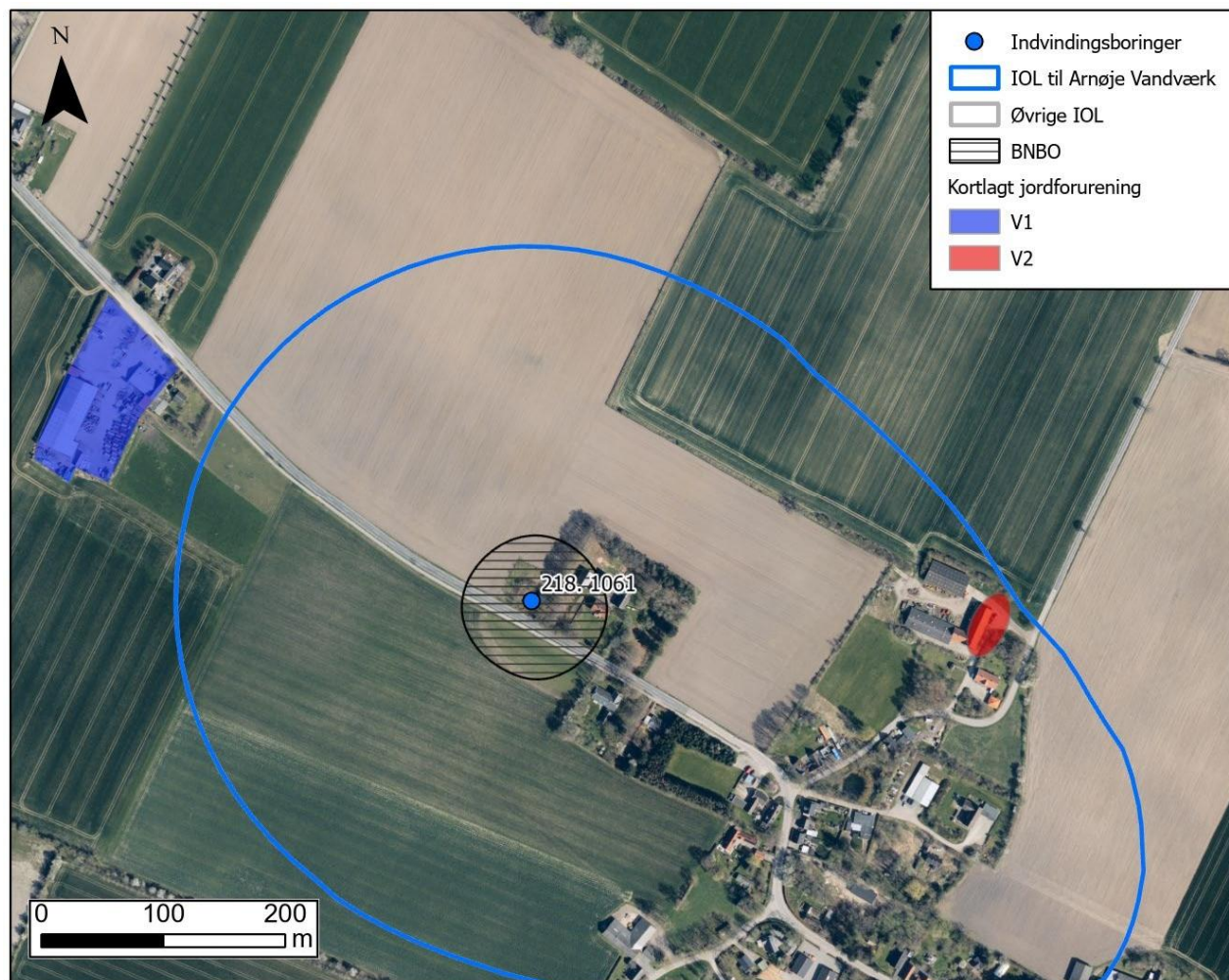
Figur B.4 Luftfoto over arealet nær indvindingsboringen til Arnøje Vandværk, der viser arealanvendelsen samt eventuel kortlagt jordforurening.
